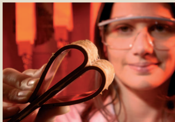
PU adhesive peeling test
